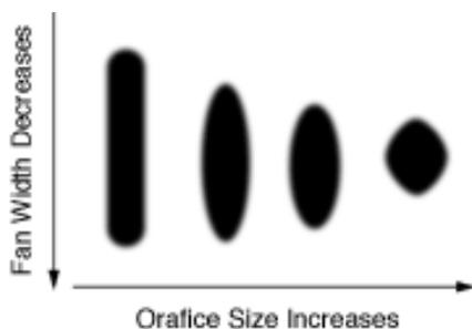
Die Lebensdauer der Düse variiert je nach Beschichtung. Sie können die Lebensdauer verlängern, indem Sie mit dem niedrigsten Druck sprühen, wodurch die Beschichtung zerlegt (zerstäubt) wird (es lohnt sich jedoch, die Empfehlungen der Lackhersteller zu befolgen)
