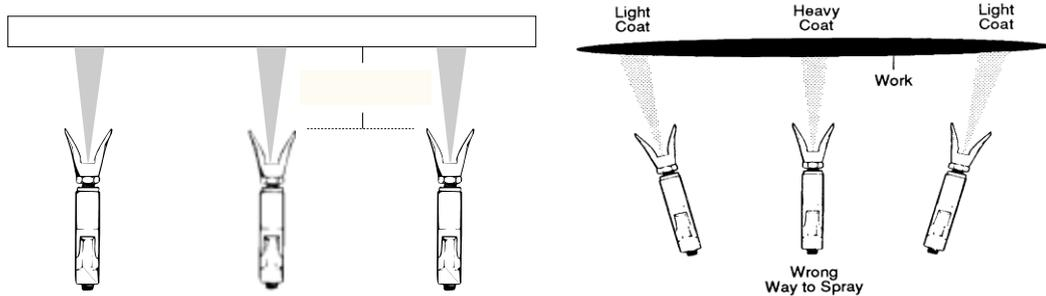
Halten Sie die Spritzpistole senkrecht zur Oberfläche, da sonst die Farbe an einigen Stellen dicker aufgetragen wird als an anderen.
