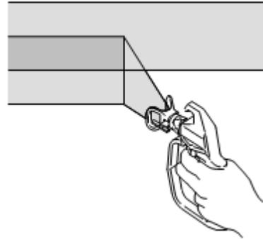
Wenn Sie eine kurze Lackierpause einlegen (bis zu 1 Stunde), verriegeln Sie den Abzug der Pistole, reduzieren Sie den Druck auf ein Minimum (Null) und bringen Sie das Sprühventil wieder in die Überlaufposition. Schalten Sie den Kühler aus und ziehen Sie den Stecker aus der Steckdose. Siehe Verfahren zum Entfernen von Überdruck.
