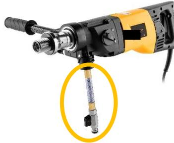
2. Auf dem Bild sehen wir Adapter für den Wasseranschluss (nass) und den Staubsauger (trocken). Diese finden Sie im Standardpaket.
