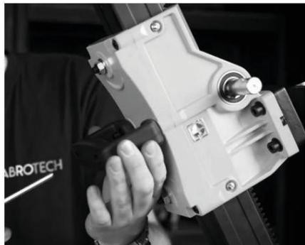
**Das Stativ ist nun einsatzbereit. Stellen Sie sicher, dass alle Komponenten fest verschraubt sind.**
