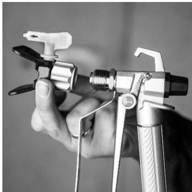
3. Wickeln Sie den Schlauch ab und verbinden Sie ein Ende mit der 1/4"-Gewindepistole. Verwenden Sie zwei Schraubenschlüssel, um das Festziehen sicher zu machen.
