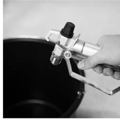
13. Lassen Sie den Auslöser los. Aktivieren Sie die Abzugssperre.
